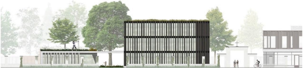
Das Konzept sieht zwei Baukörper vor. Ein Dreigeschosser reiht sich in Volumen, Lage und Höhe an der Hermannstraße in die vorhandene und zukünftige Bebauung der Einzelbaukörper wie selbstverständlich ein. Das zweite über ein Dach mit dem Hauptbau verbundene Langhaus erstreckt sich entlang der Friedhofsmauer und verbindet über eine landschaftliche Treppe den hinteren Garten mit dem begrünten Dach. Hier beginnt ein Lehrpfad, der bis zum Haupthaus führt.
